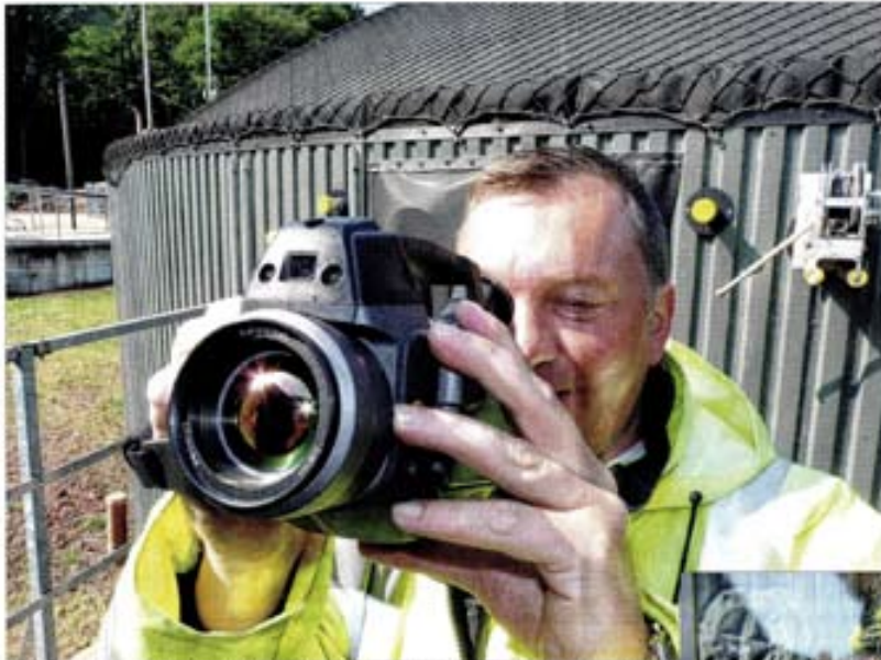
Ein Blick durch die Kamera verrät Stephan Neitzel, ob irgendwo Gas austritt, und damit auch, ob die Wirtschaftlichkeit und die Sicherheit eingeschränkt sind. Foto: Björn Meyer
