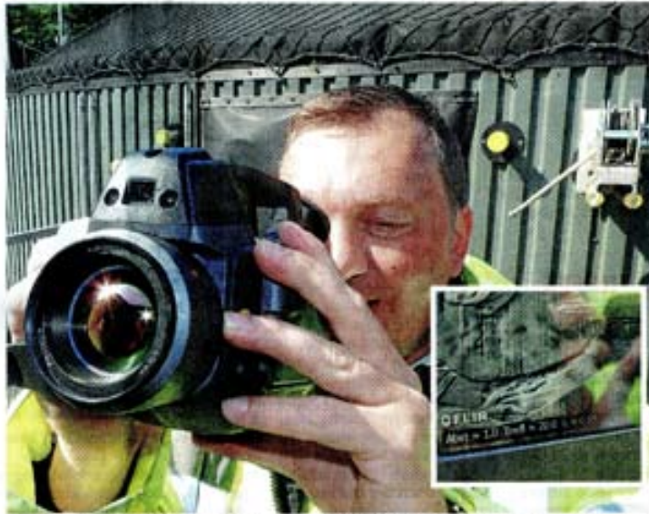
Ein Blick durch die Kamera verrät Stephan Neitzel, ob irgendwo Gas austritt und damit die Wirtschaftlichkeit und die Sicherheit eingeschränkt sind.
